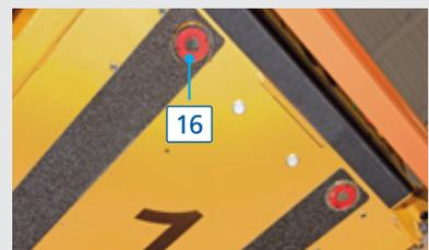
**Sistema de bloqueo (16):** asegura la fijación del carro sobre las palas del autelevador, evitando que se mueva durante su desplazamiento.
