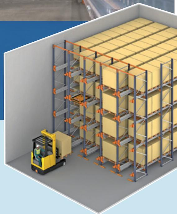
El carro realiza los movimientos de forma autónoma, sin necesidad de que los autotelevadores entren en las calles de almacenamiento, siguiendo las órdenes lanzadas por un operario a través de una tablet con conexión wifi.
