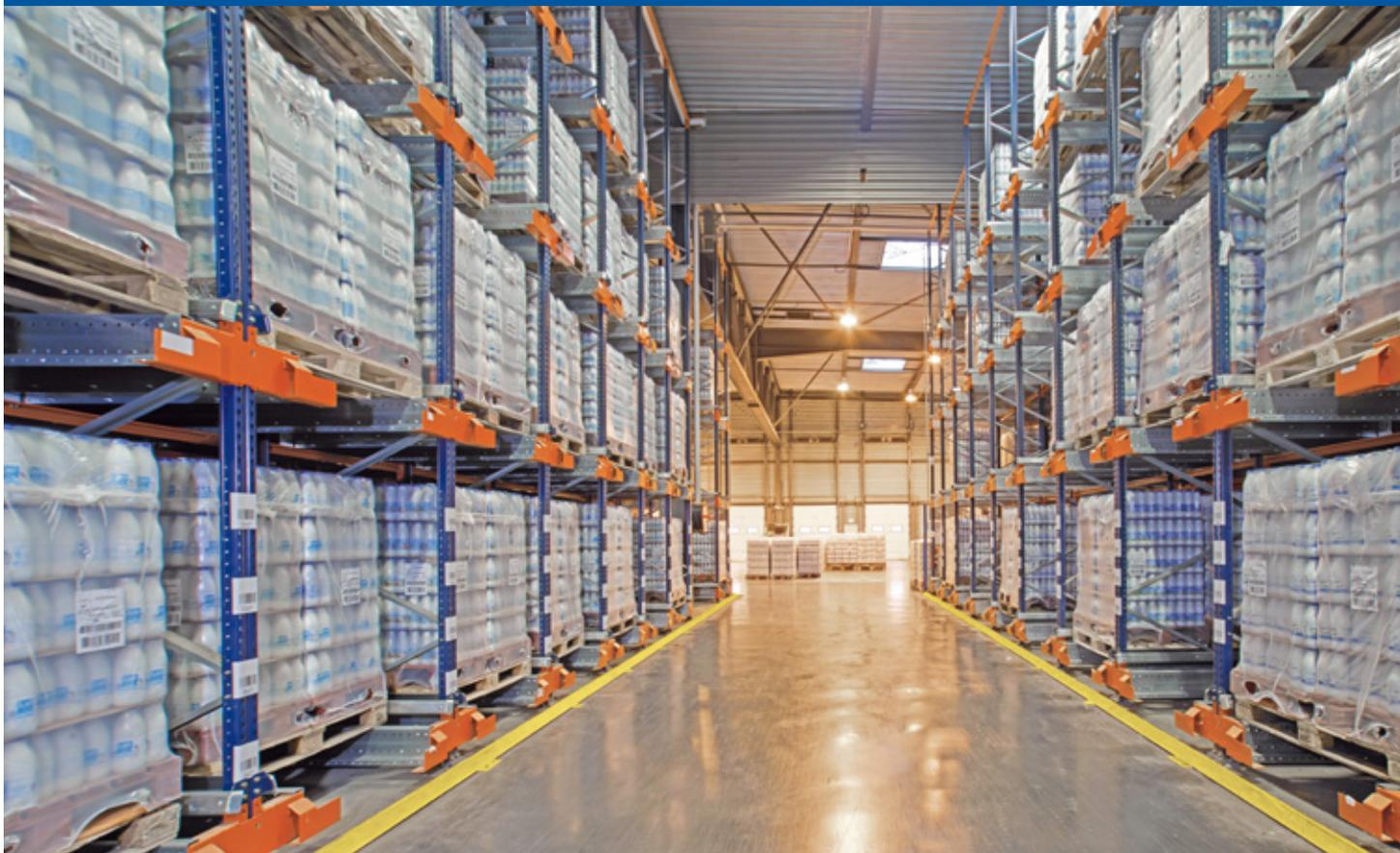
En las instalaciones semiautomáticas con Pallet Shuttle, los autelevadores depositan los pallets sobre los carriles en la entrada del nivel y el carro eléctrico los recoge y los desplaza hasta la primera ubicación libre en el canal, compactando así al máximo la carga.
