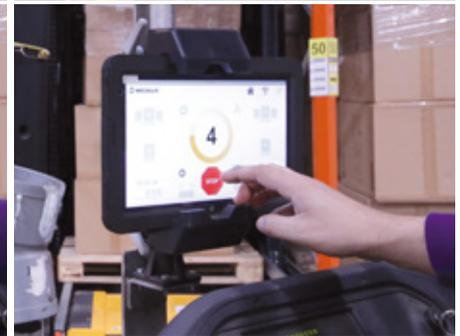
Para poder acceder a la tablet desde una posición ergonómica y segura, existe un soporte que se fija directamente a la estructura de protección del autelevador, en la parte superior (techo) o en uno de los perfiles verticales de sustentación. Así, la tablet se encaja en la bandeja del soporte y puede extraerse fácilmente.
