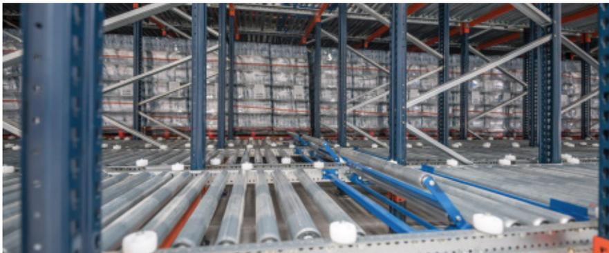
Los canales dinámicos tienen una inclinación del 4%, lo que facilita el desplazamiento por gravedad de los palets desde la parte más alta (entradas) a la más baja (salidas)
