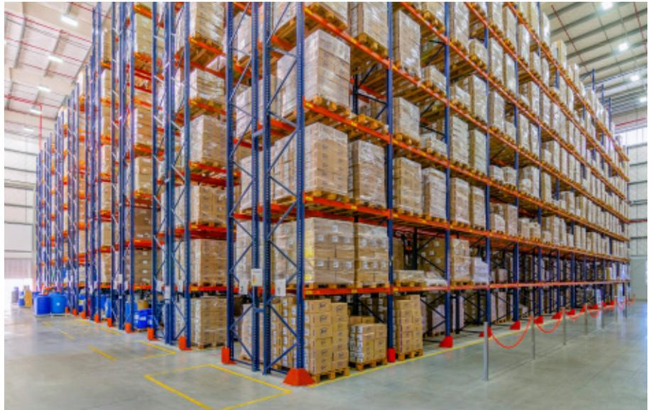
Los pallets con materias primas se depositan en los niveles inferiores de los racks porque son más pesados y accesibles
