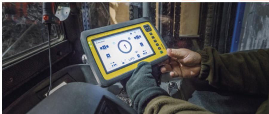
El operario de la carretilla comunica las órdenes al carro mediante una tableta con conexión wifi preparada para trabajar en frío
