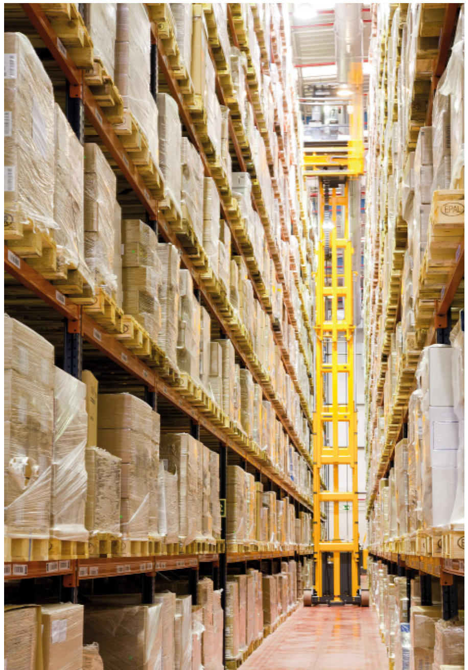
Máquina contrapesada para operar entre zonas y alimentar la cabecera del almacén principal
