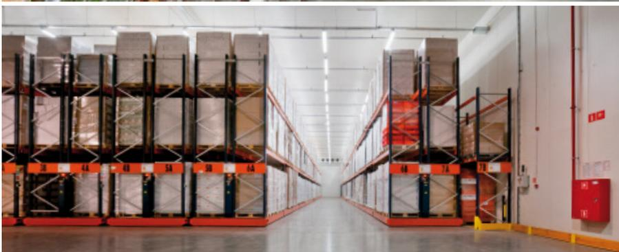
Mecalux ha instalado estanterías convencionales y estanterías sobre bases móviles Movirack en el centro logístico de JAS-FBG S.A. La combinación de ambas soluciones permite maximizar la capacidad de almacenaje e incrementar la productividad, al clasificar los productos según su tamaño y rotación.
