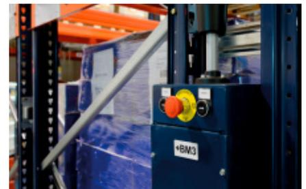
Los dos bloques de estanterías Movirack disponen de su propio armario de control y armarios embarcados en cada una de las estanterías. En el armario de control se encuentra el PLC, encargado de dirigir y procesar las órdenes de movimiento.
